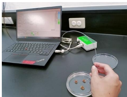
圖 9: 珊瑚體內共生藻光化學效率測定示意圖(諮詢人員協助拍攝)
